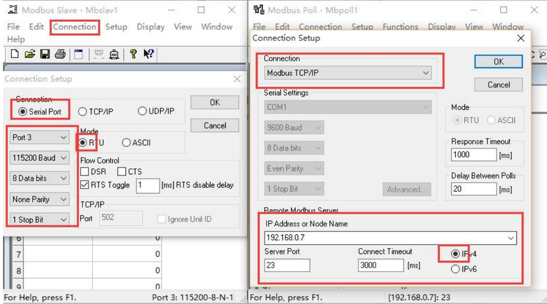
图 36 Modbusrtu 转 Modbus tcp 软件设置截图
