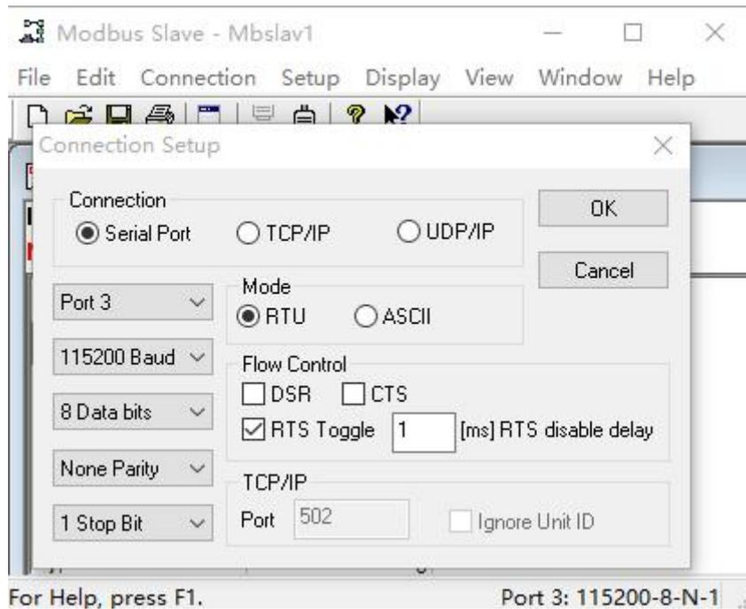
图 39 Modbusrtu 主动查询设置截图
