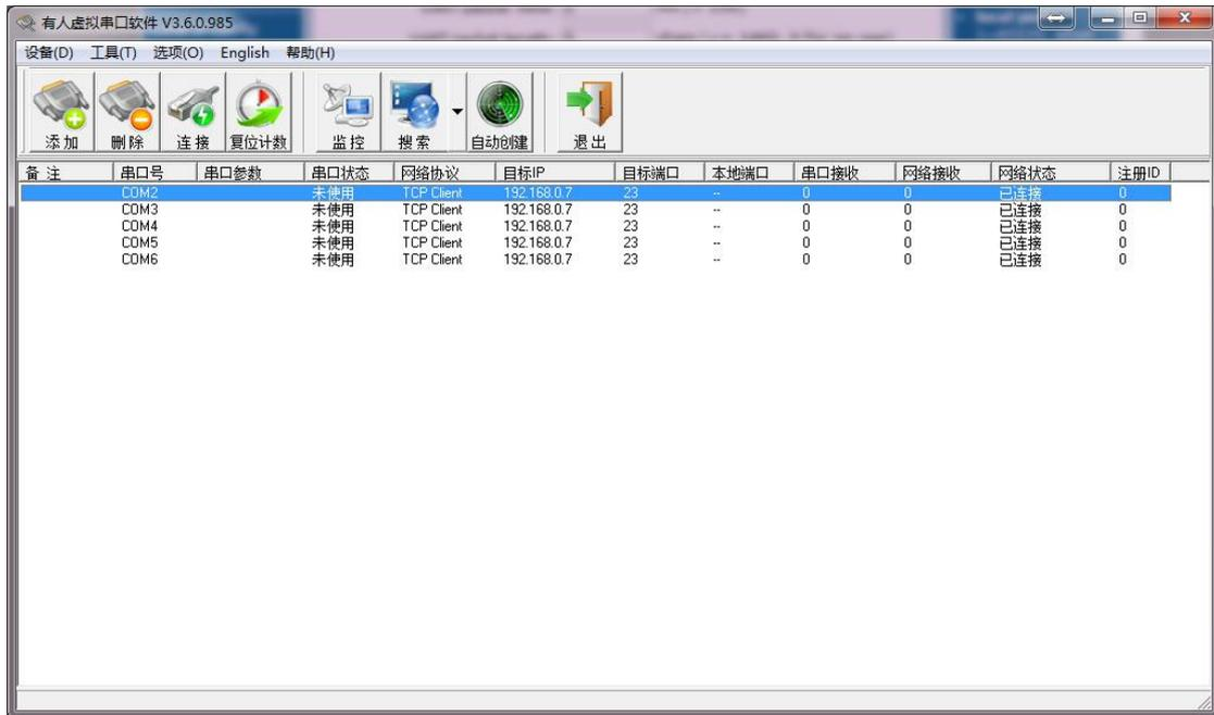
图 43 Modbus 虚拟串口设置截图
