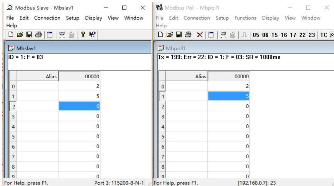
图 37 Modbusrtu 转 Modbus tcp 转换结果
